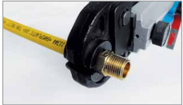
**5)** Predisporre la macchina pressatrice con la ganaschia idonea al diametro del tubo e posizionarla in modo che la ghiera sia correttamente inserita nella sede specifica.
