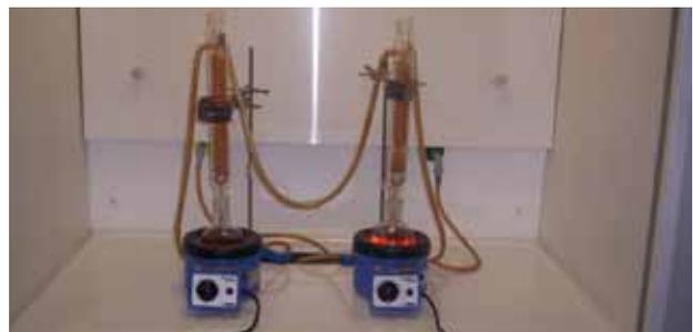
Fig. 2 Bagno di prova secondo UNI EN 579
