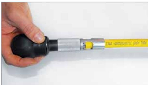
**3)** Rifilare e sbavare con cura le estremità, al fine di non provocare possibili danneggiamenti agli o-ring che potrebbero compromettere la tenuta della giunzione.
